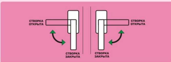
Рис. 1 Схема поворота ручки для открывания поворотной створки
